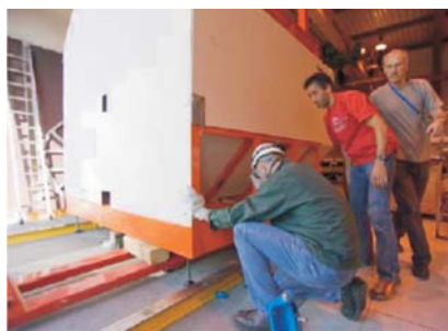
Рис. 33. Установка защиты детектора перед транспортировкой
