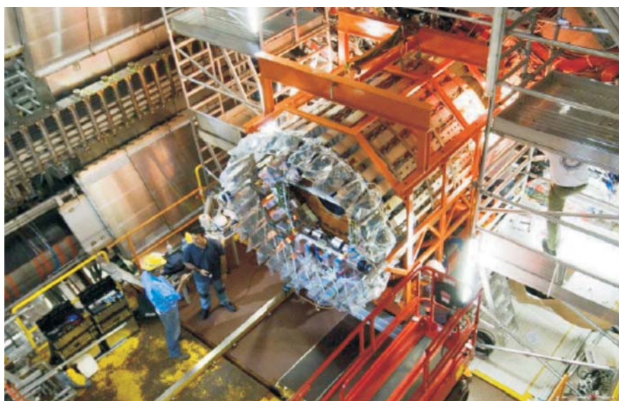
Рис. 36. Установка ЕС во внутренний детектор
