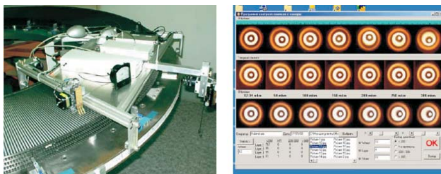
Рис. 7. Слева — общий вид устройства, проводящего проверку кривизны и отсутствия резистивных контактов установленных строу. Справа — изображение на мониторе исследуемой на кривизну строу
