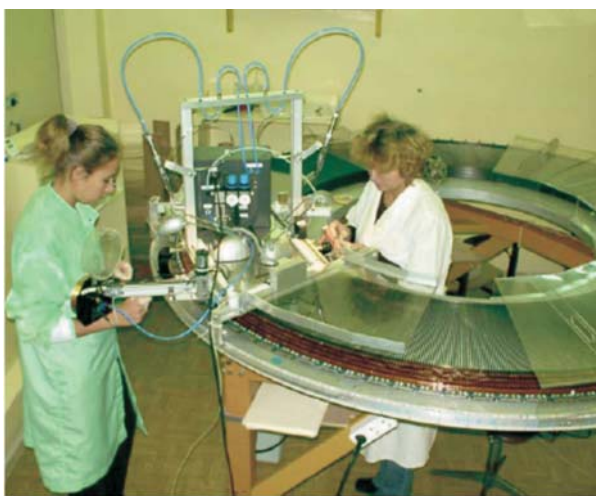
Рис. 23. Установка анодных проволочек в строу
