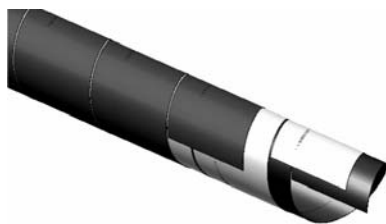
Рис. 11. Схематичное изображение конструкции строу
