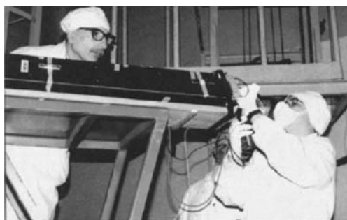
Рис. 4. Установка модуля баррельного детектора на канале реактора ИБР-30. Справа сотрудник Университета шт. Индиана (США) П. Ганьон (P. Gagnon)
