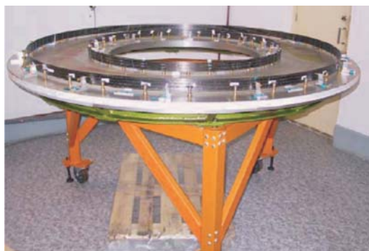
Рис. 18. Сборочный стол с установленными композитными кольцами
