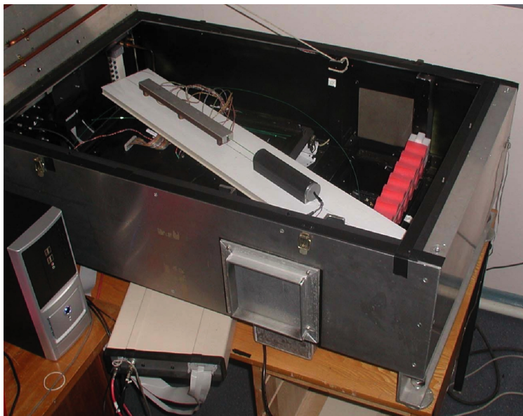
Рис. 4. Стенд для измерения коротких волокон в светозащитном кожухе
