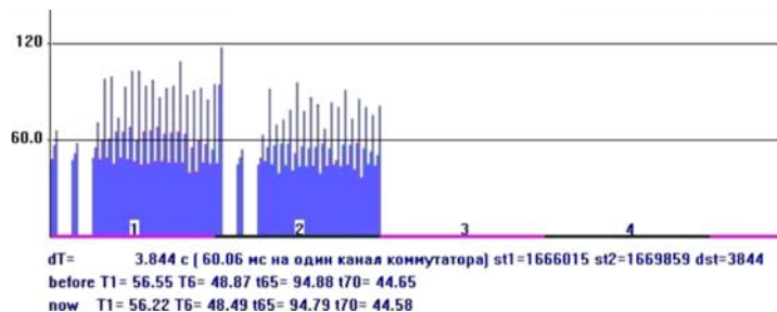
Рис. 5.4. Результаты измерения температуры элементов нуклотрона в процессе охлаждения. 44-й сеанс
