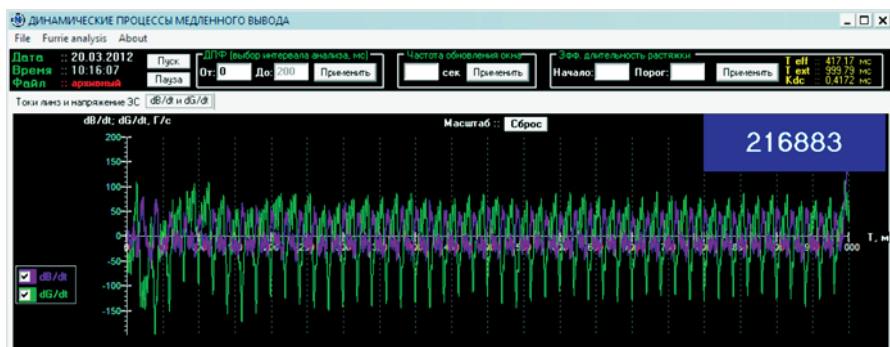
Рис. 3.2. Пульсации дипольных ( dB/dt — источник 19ТВ + 20ТВ) и квадрупольных полей ( dG/dt — источник 37ТВ) на «столе» магнитного поля 15 кГц (45-й сеанс, 20 марта 2012 г.)
