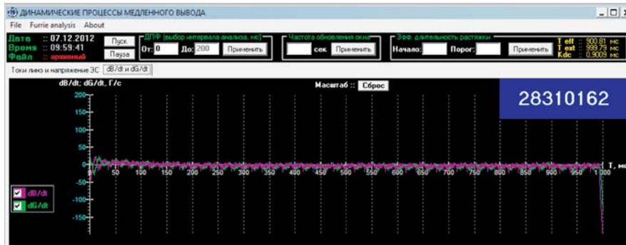
Рис. 3.4. Пульсации дипольных ( dB/dt — источник 19ТВ + 20ТВ) и квадрупольных полей ( dG/dt — источник 37ТВ) на «столе» магнитного поля 14 кГц (46-й сеанс, 7 декабря 2012 г.). Масштаб по вертикальной оси тот же, что и на рис. 3.2
