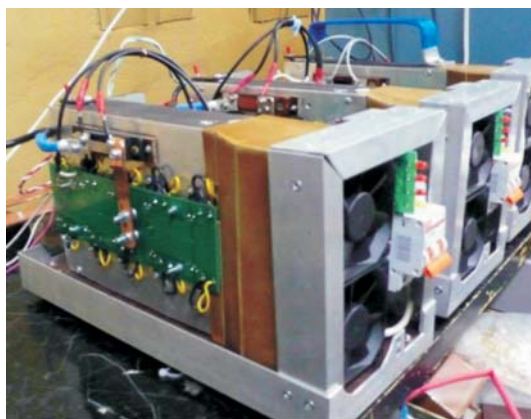
Рис. 3.3. Модуль регулятора тока 50 А × 10 В, пиковая нагрузка до 1,2 кВт
