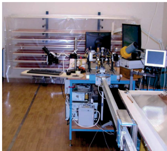
Рис. 2. Устройство для ультразвуковой сварки трубок
