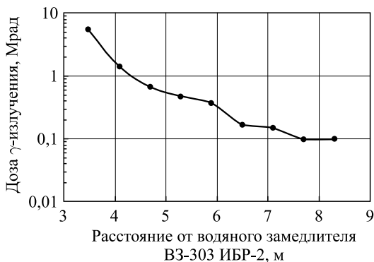
Рис. 4. Зависимость дозы \gamma -излучения от расстояния до водяного замедлителя ВЗ-303 ИБР-2
