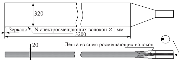
Рис. 28. Модернизированные сцинтилляционные счетчики CSP (размеры указаны в мм)
