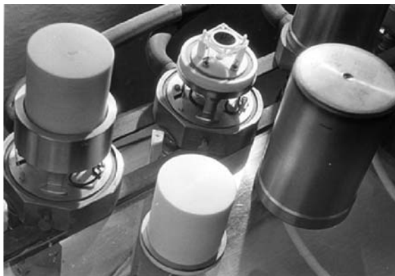
Рис. 1. Камеры для низкофонных измерений. Показан один из двух детекторов в открытой камере. Слева — открытая внешняя камера. Показан один из пары детекторов
