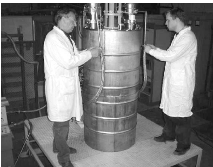
Лаборатория физики частиц. Узлы нового ускорителя для радиационных технологий: система формирования импульсного питания (слева), вакуумная камера с высоковольтной линией (справа)
