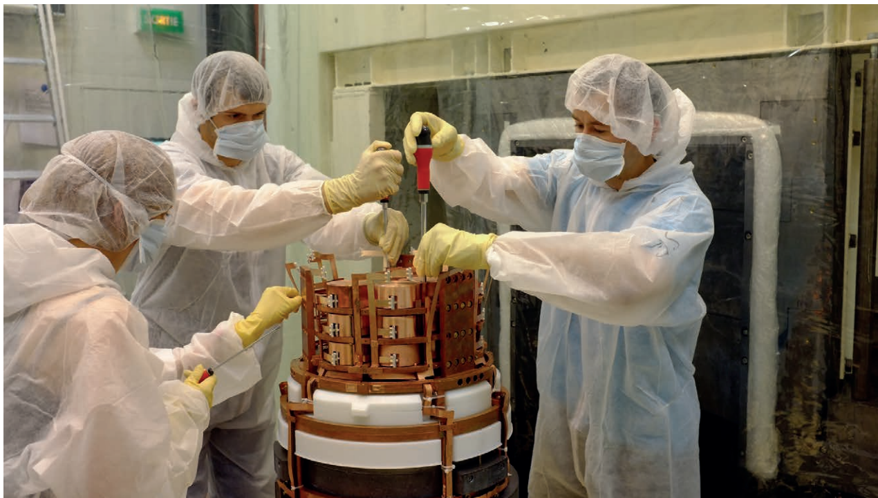
Моданская подземная лаборатория (LSM, Франция). Процесс сборки детектора EDELWEISS-III
