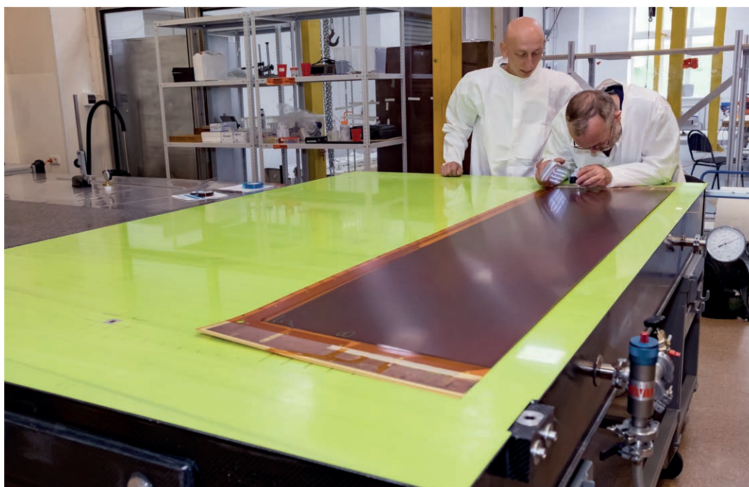
Лаборатория ядерных проблем им. В. П. Джелепова. Проверка считывающих печатных плат камер Micromegas для установки ATLAS
