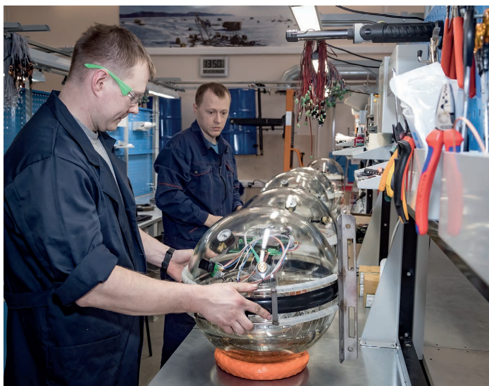
Лаборатория ядерных проблем им. В. П. Джелепова. Сборка оптических модулей для проекта «Байкал-GVD»
