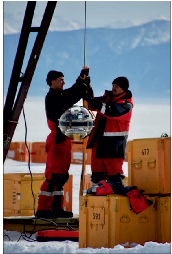
Очередной оптический модуль телескопа подготовлен к погружению
