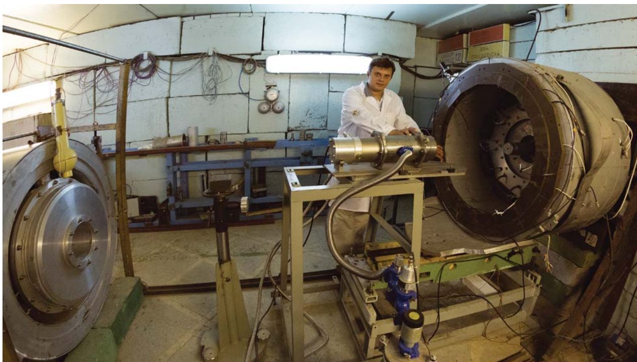
Лаборатория нейтронной физики им. И. М. Франка. Спектрометр ДН-12 для исследования микрообразцов методом рассеяния нейтронов при высоких давлениях
