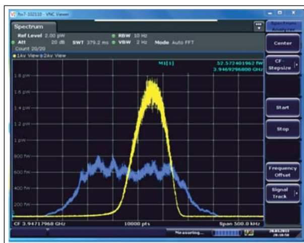
Рис. 1. Спектр продольного дробового шума пучка на 3048-й гармонике частоты обращения. Нижняя кривая (голубая) — сразу после инжекции, желтая кривая — после 8 мин охлаждения. Энергия дейтронов 3 ГэВ/нуклон, интенсивность пучка 10^9 частиц
