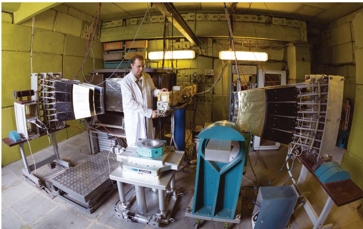
Лаборатория нейтронной физики им. И. М. Франка. Фурье-дифрактометр для анализа внутренних напряжений методом нейтронной дифракции высокого разрешения ФСД
