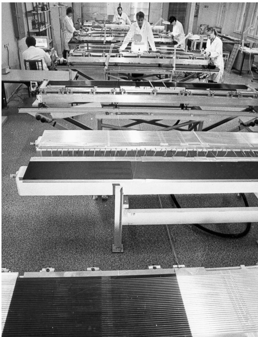
Лаборатория сверхвысоких энергий. Участок сборки серийных модулей камер из поколона-С для установки HERA-B в DESY (ФРГ)
