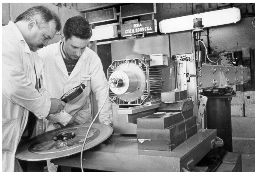
Лаборатория нейтронной физики им. И.М.Франка. Монтаж нейтронного прерывателя дифрактометра ФСД для исследований механических напряжений в материалах
