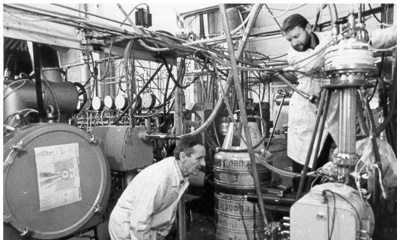
Лаборатория ядерных проблем. Сборка нового оборудования для исследования процессов мю-катализа
