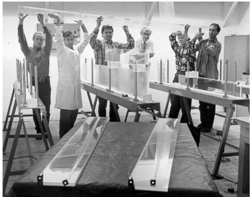
Лаборатория ядерных проблем. Работы по созданию крупных сцинтилляционных счетчиков для модернизации спектрометрического комплекса CDF на тэватроне FNAL (США)
