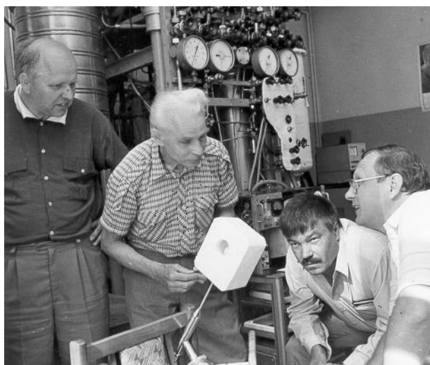
Лаборатория ядерных проблем. Испытания криогенной медицинской аппаратуры, разработанной в лаборатории для хирургических и косметических операций
